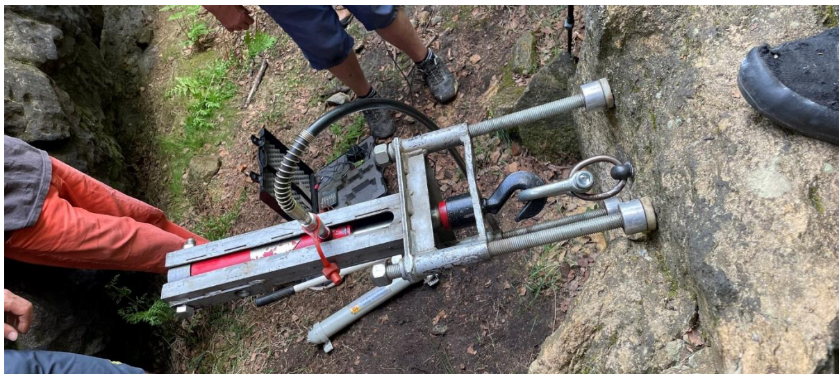
Obrázek 8 - Zkouška zatížení kruhu během školení správců skal
