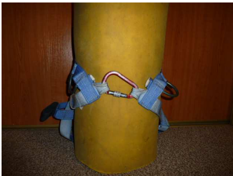
Nevhodné spojení jistících ok úvazu
