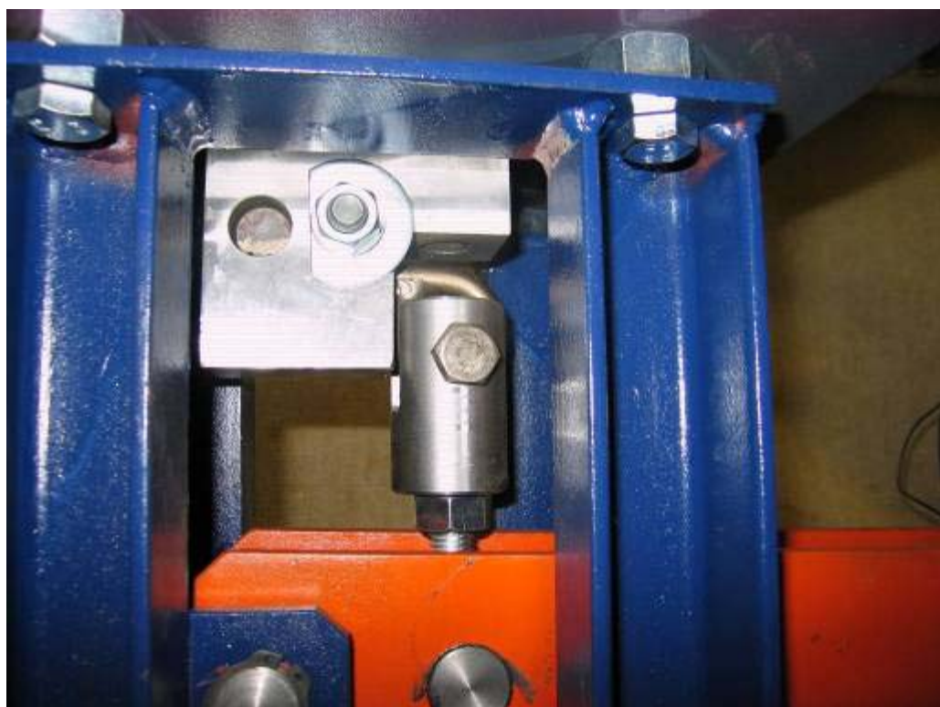
Zkoušený borhák je upnut v přípravku pro statické zkoušky
