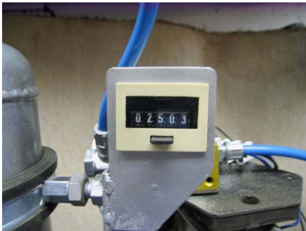
Stav počítadla po zkončení dynamické zkoušky
