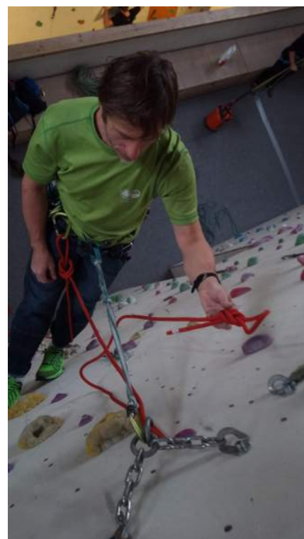
Protažení lana vratným bodem, jeho zajištění proti ztrátě do sedáku a uzel na konci.
