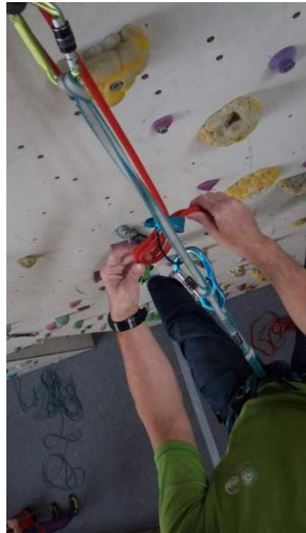
Přitáhneme co nejvíce lano tak, aby nebylo volné mezi sлаňovacím bodem a pomůckou.
